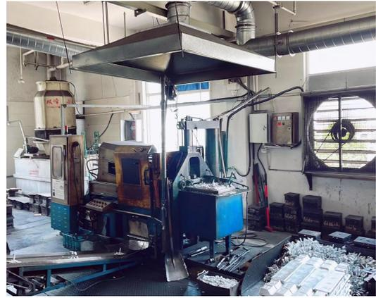
压铸废气收集装置
