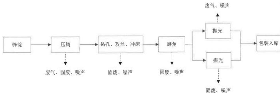
**图 2-2 五金拉手生产工艺流程图**
